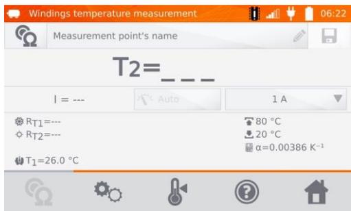
8 Schließen Sie das Prüfgerät an den Motorwindungen an. Drücken Sie **START/STOP**.
